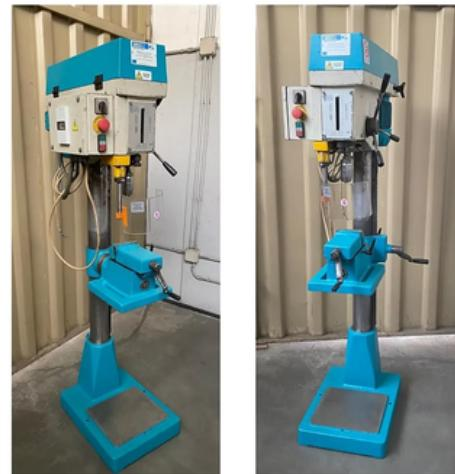
**Trapano a Colonna mod. 25 mm****Caratteristica** Valore**Diametro massimo di foratura****25 mm (FE)****Diametro massimo di filettatura****16 mm****Controllo****Manuale****Corsa canotto****124 mm****Velocità di rotazione****115 – 1910 rpm****Attacco cono****3****Misura canotto****62 mm****Dimensione colonna****92 mm****Peso macchinario****245 kg****Sicurezza****Pulsante e dispositivi****Normativa****Conforme normative CE****Codice prodotto****250663**
